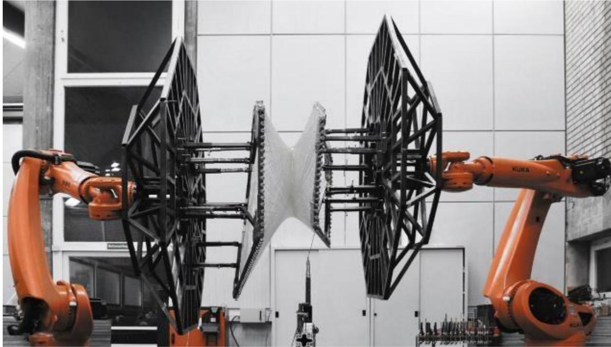
Abbildung 10: Kernloses Faserwickeln, in Epoxidharz imprägnierte, kostengünstige Glasfasern bilden die gedachte Schalung, Carbonfasern verstärken die höher beanspruchten Bereiche
