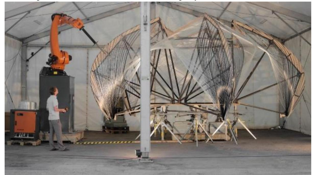
Abbildung 6: Fabrikation des kernlos gewickelten Forschungspavillons 2012, glasfaserverstärktes Epoxidharz mit Carbonfaserverstärkungen in den hochbeanspruchten Bereichen
