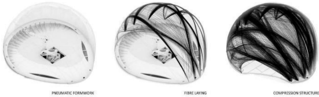
Abbildung 13: Herstellungsprozess v.l.n.r.: pneumatische Schalung, robotisches Faserlegen von innen, Carbonfasern als aufgelöstes Schalenträgerwerk
